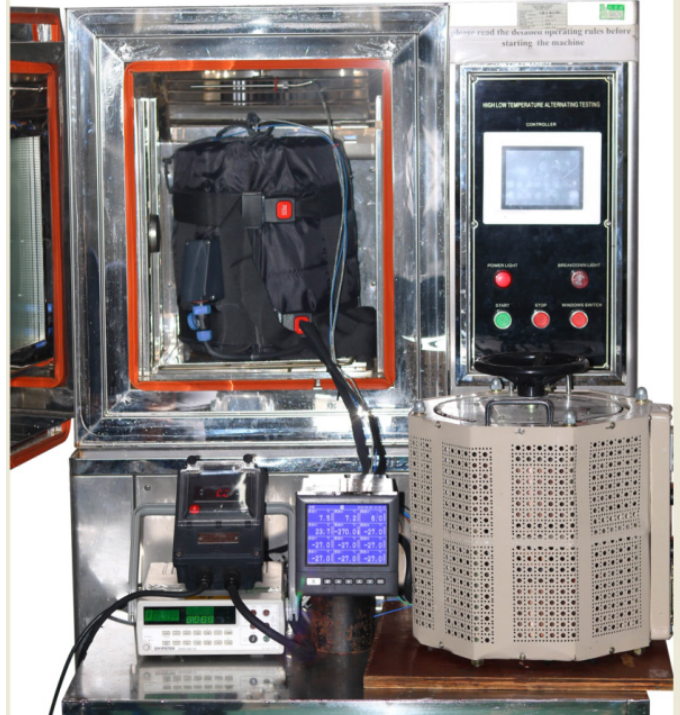
Couverture chauffante en cours d'essais climatiques en températures négatives
