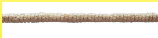
1960 ca corde chauffante Calor, diamètre 1.7mm, fil chauffant unique en nickel chrome diamètre 0.08mm, sur âme en coton légèrement torsadée pour éviter le bouclage. (collection Ultimheat)
